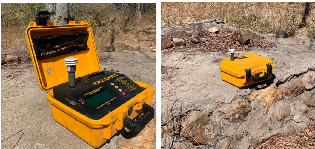
Figura 10: Processo de amostragem através do Haz-Dust
