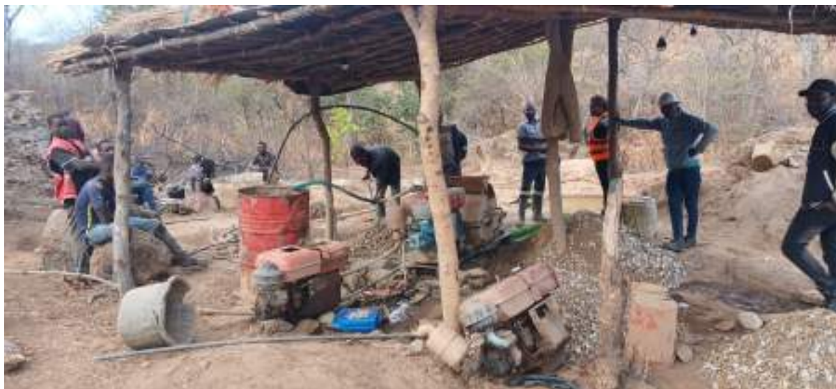
Figura 6-10: Motores usados para moagem de rochas primárias para extração de ouro
