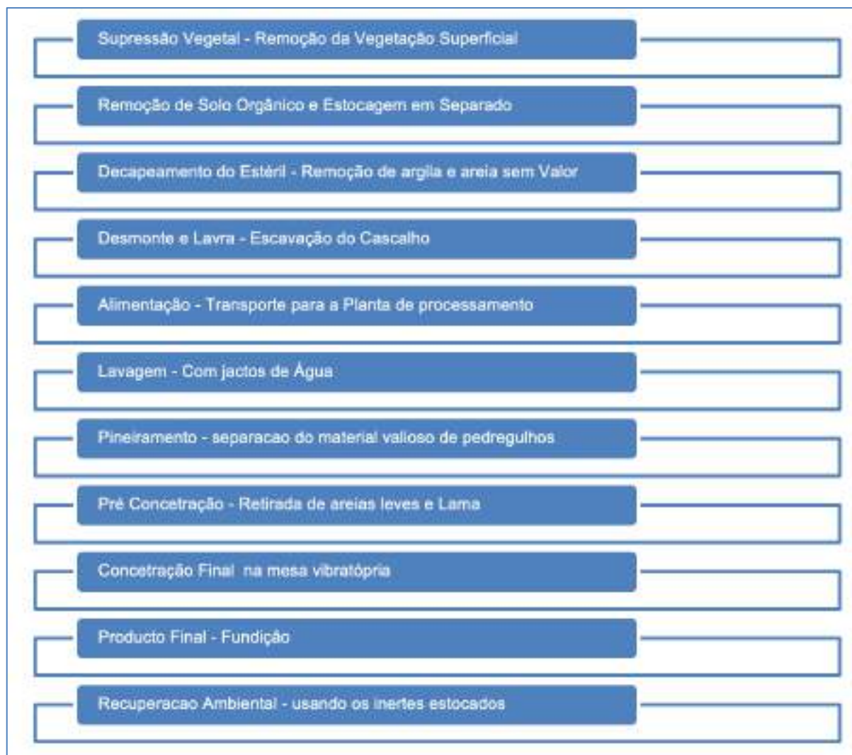
Figura 3-3: Fluxograma do processo de extração de ouro aluvionar
