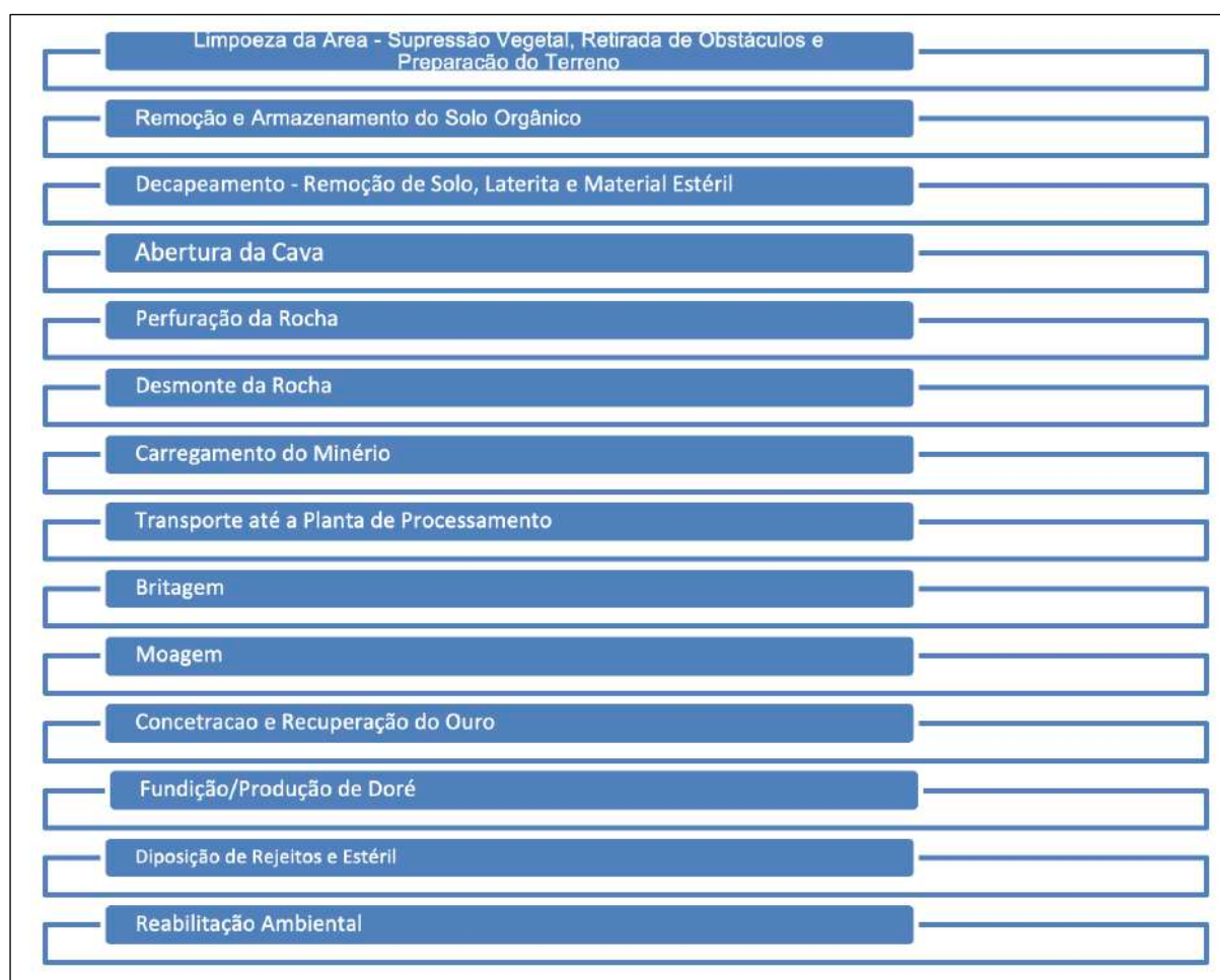
Figura 3-2: Fluxograma do processo de extração de ouro em Rocha Primária
